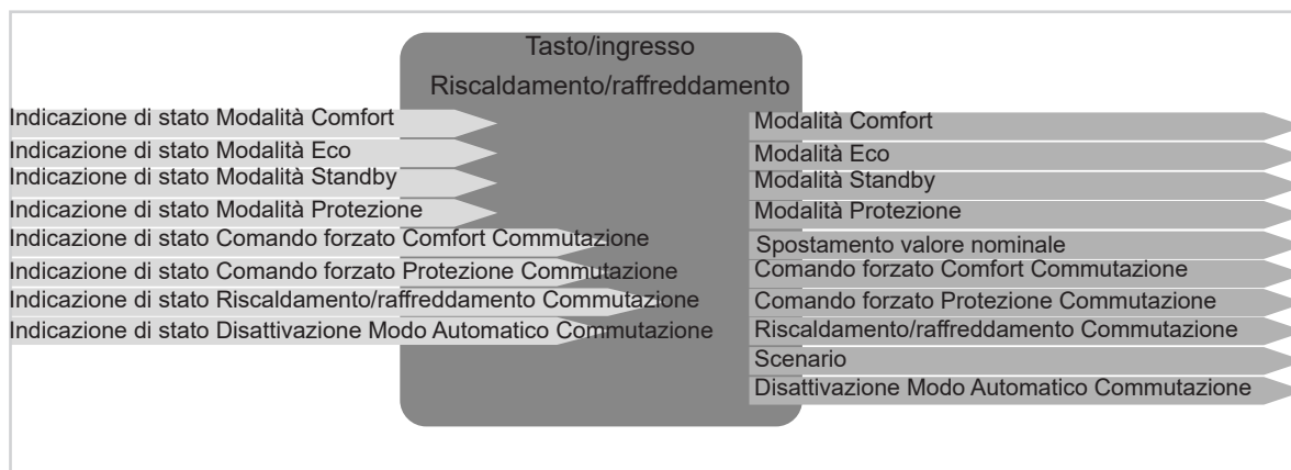
Figura 7: Segnali di ingresso/uscita funzione Riscaldamento/raffreddamento
