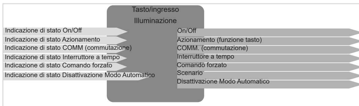
Figura 4: Segnali di ingresso/uscita funzione illuminazione
